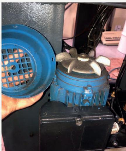
Motor da bomba de lubrificação
